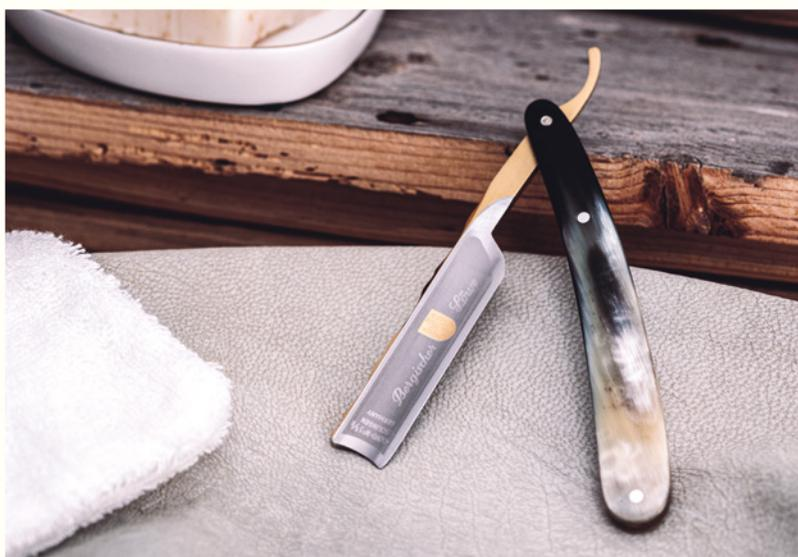
Eine perfekte Rasur erfordert ein gutes Rasiermesser. Klassische Rasiermesser bestehen aus Klinge mit Erl und Angel sowie zwei Schalen (Griffplatten). Im Vergleich zu anderen Messern verfügen Rasiermesser über einen Hohlschliff. Einer der wichtigsten Schritte bei der Messerproduktion: die Vergütung – der Rohling wird dafür erhitzt und mit Öl abgeschreckt.
